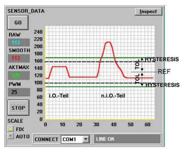
Das Messobjekt Referenzobjekt (Gut-Teil) wird in der Lichtmessstrecke so platziert, dass die Lichtmessstrecke halb bedeckt wird (Referenzwert REF=128). Empfänger des Sensors am detektierte Intensität ist der Abdeckung an der Lichtmessstrecke proportional. diesen Referenzwert wird
